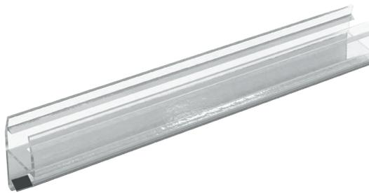
Perfil de policarbonato con magneto para instalación lateral en corredizos o batientes a 180° y 90°, funciona como tope y atrape al centro. \*Se surte en pares, ya que un lado corresponde al magneto positivo y otro al negativo. El perfil tiene un largo de 2.50m.
