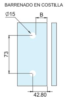
Para determinar la posición de los barrenos en el vidrio:
