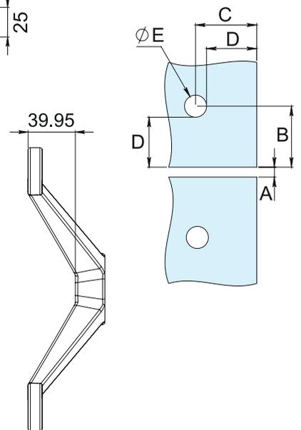
Para determinar la posición del barreno en el vidrio:
