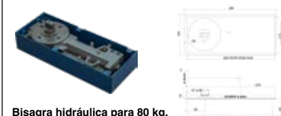
Bisagra hidráulica para 80 kg. Con eje rectangular. • Medidas para perforación: 268mmx113mmx50mm • Material de cubierta: Acero inoxidable
