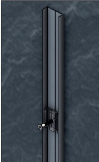
**Paso 5.-** Centrar el soporte plástico en la parte superior de la jamba y marcar las
