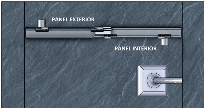
**Paso 8.-** Monte las carretillas en los paneles, tomando en cuenta que la parte más larga de las jaladeras queden hacia el mismo lado que la rueda de la carretilla. Apriete los tornillos en cada carretilla de forma uniforme, comenzando por los tornillos de los extremos hasta que todos estén bien apretados. Revise que las rodajas de cada carretilla estén apretadas.
