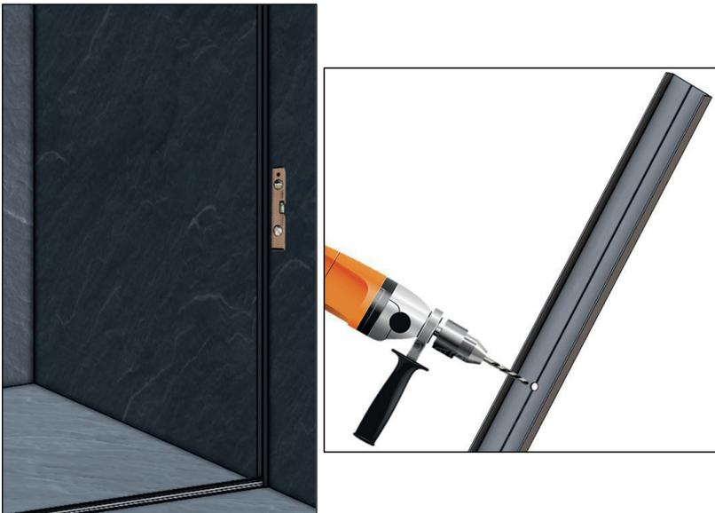
**Paso 3.-** Colocar las jambas en su posición y centrarlas correctamente, realizar las perforaciones en el muro con broca para concreto de 1/4" conforme a perforaciones realizadas en el paso anterior, insertar taquetes en las perforaciones a muro con ayuda de un martillo.
