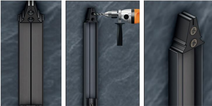
**Paso 6.-** Mida el claro en la parte superior de los soportes (de muro a muro) y corte el riel a esta dimensión menos 3mm. Coloque el riel superior en los soportes y haga presión firmemente hacia abajo desde la parte superior hasta que escuche un clic, repita en el otro extremo del riel.
