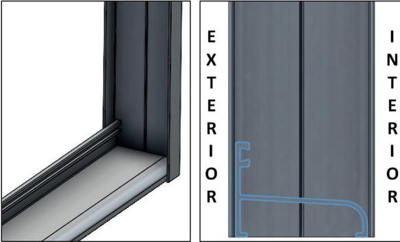
**Paso 2.-** Use un nivel de burbuja para plomear ambas jambas laterales. Marque con un lápiz ambos lados de las jambas. Realice 2 perforaciones con broca de 1/4" a lo largo del centro de las jambas, procurando que queden equidistantes, puede ayudarse con el canal guía del centro de la jamba.
