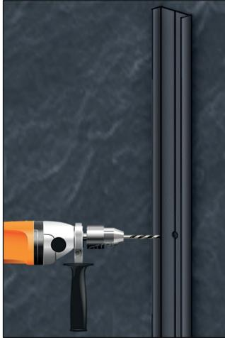
**Paso 4.-** Atornille con las pijas ambas jambas al muro, colocando en las perforaciones los topes plásticos.
