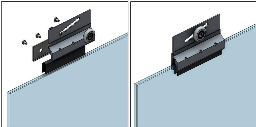
**Paso 9.-** Levante el panel interior en posición para que las ruedas de las carretillas asienten en el canal interior del riel. Repita la misma operación para el panel exterior. Si los paneles no quedan paralelos a su respectiva jamba, desmonte y ajuste las ruedas de las carretillas sobre los orificios según sea necesario.
