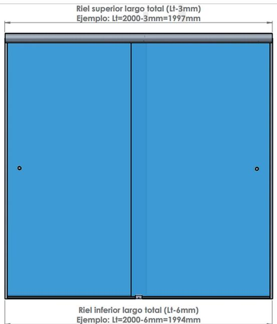
Para **corte de vidrio** el alto siempre será de 1926mm considerado para un cancel con altura de 2mt, para el ancho será  $(Lt/2)+25$ , para barreno de perilla a una distancia de 950mm del canto inferior de vidrio al centro del barreno y 100mm de canto lateral. Ejemplo:
