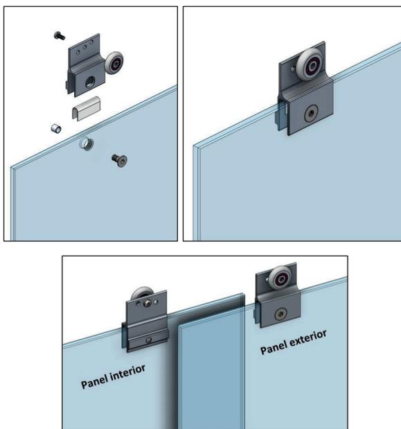
**Paso 9.-** Levante el panel interior en posición para que las ruedas de las carretillas asienten en el canal interior del riel. Repita la misma operación para el panel interior. Si los paneles no quedan paralelos a su respectiva jamba, desmonte y ajuste las ruedas de las carretillas sobre los orificios según sea necesario.
