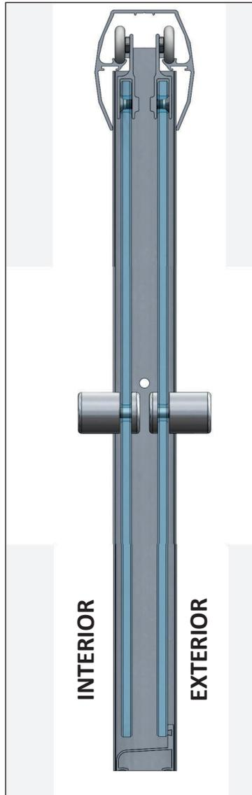
**Paso 10.-** Coloque la guía de piso al centro del cancel sobre el perfil inferior. Con una broca de 5/32" perforo a través del barreno de la guía de piso. Fije la guía con el tornillo incluido en el kit.
