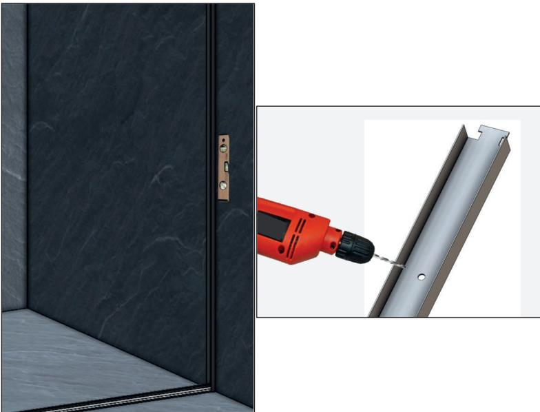
**Paso 3.-** Colocar las jambas en su posición y centrarlas correctamente, realizar las perforaciones en el muro con broca para concreto de 1/4" conforme a perforaciones realizadas en el paso anterior, insertar taquetes en las perforaciones a muro con ayuda de un martillo.
