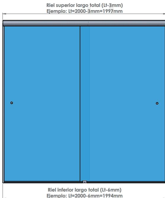
Para **corte de vidrio** el alto siempre será de 1938mm (considerado para un cancel con altura de 2mt), para el ancho será  $(Lt/2)+50$ , barrenos para carretilla a una distancia de 15mm del canto superior de vidrio al centro del barreno y 100mm de cantos laterales, diámetro de barrenos de 10mm, para barreno de perilla a una distancia de 950mm del canto inferior de vidrio al centro del barreno y 100mm de canto lateral. Ejemplo:
