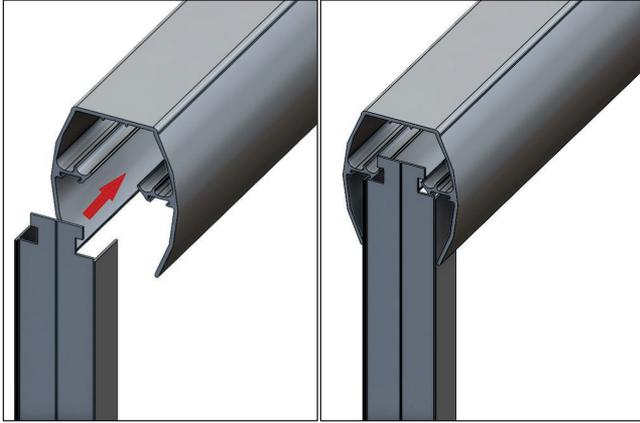
**Paso 6.-** Tome el perfil inferior y coloque silicón en las cejas de la parte inferior, colóquelo entre las 2 jambas con la parte alta hacia el exterior del cancel y presione el perfil de manera uniforme contra el piso, retire el exceso de silicón.
