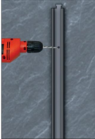
**Paso 4.-** Atornille con las pijas solamente una de las jambas al muro, colocando en las perforaciones superior e inferior los topes plásticos y en la perforación del centro de la jamba, únicamente atornillar la pija.
