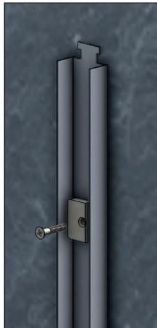
**Paso 5.-** Mida el claro en la parte superior de las jambas y corte el riel a esta dimensión menos 3mm. Tome la jamba que no está instalada e introdúzcala en el riel superior. Introduzca el otro extremo del riel superior en la jamba ya instalada. Atornille la jamba siguiendo las mismas indicaciones del paso 3.
