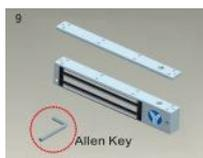
Use una llave Allen para retirar la placa de montaje de la carcasa de la cerradura.
