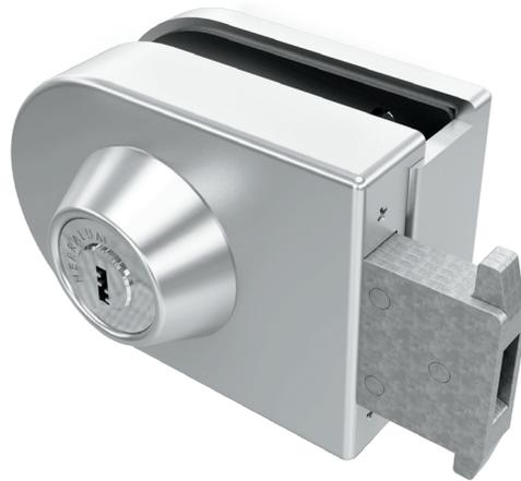
Chapa Maruata para puerta batiente ó corrediza de vidrio templado, la chapa incorpora un perno para realizar un barreno cuando se instala en corrediza; en la instalación de batiente puede prescindir del barreno pero hay que cortar el perno. \*Compatible con contra 1153.
