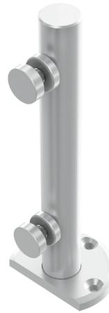
Poste Monterrey de 25cm de largo con tubo de 1-1/4" calibre 20 para cristal templado. Cuenta con sistema de sujeción con tuerca remachable. Instalar en cristales con una altura máxima de 1.20m y con una separación no mayor a 1.50m entre postes.
