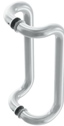
Jaladera Zirahuén tubular tipo curvo de 1" de diámetro, sistema de ensamble por medio de tornillo con cono integrado. Medida de línea 30cm de largo total con 27.5cm de centro a centro.
