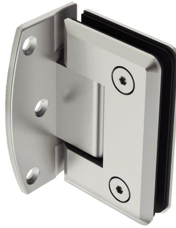
Bisagra muro a vidrio con apertura de 180° y base descentrada para cancel de baño con cristal templado. La bisagra cierra sola a partir de 25° en ambas direcciones.
