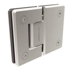
Bisagra vidrio a vidrio a 180° para cancel de baño con cristal templado. La bisagra cierra sola a partir de 25° en ambas direcciones.
