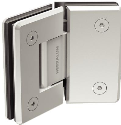
Bisagra vidrio a vidrio a 135° para cancel de baño con cristal templado. La bisagra cierra sola a partir de 25° en ambas direcciones.
