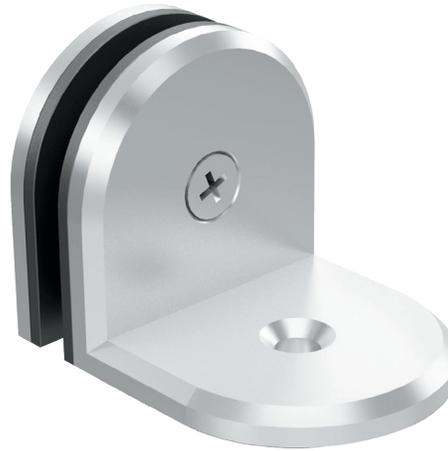
Conector curvo con base lateral para fijos de vidrio templado. Instalar a 1.50m de separación máxima entre conectores. \*Anclar a muro con taquete expansivo.
