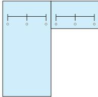
Los barrenos en el antepecho y los fijos tienen una separación recomendada entre centros de 400 y 500mm
