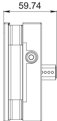
Chapa Zamora para vidrio templado, recomendable para instalación muro a vidrio y vidrio a vidrio en conjunto con la contra 1277C ó al piso. La sujeción al vidrio es mediante presión, lo cual hace que no requiera resagues en el cristal. Fabricada con acabados que hacen a este producto resistente a la corrosión y prolonga su vida útil.
