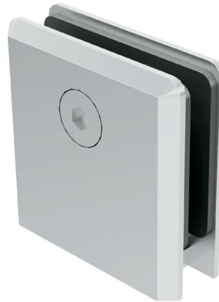
Conector con base chica y un tornillo de fijación. La instalación del vidrio queda a paño. Se recomienda instalar un conector cada 1.50m de separación máxima. \*Anclar a piso ó muro con taquete expansivo.
