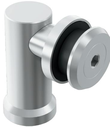
Conector León muro a vidrio para cristal templado. Instalar un conector cada 1.50m de separación máximo, y en caso de que el cristal supere 1m de altura, instalar conectores en la parte superior ó en los laterales. \*Anclar a piso ó muro con taquete expansivo y pija.
