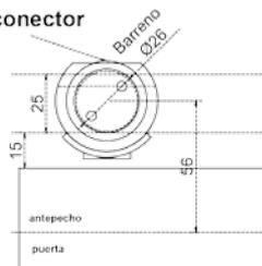
CONECTOR DE ANCLAJE LATERAL MURO - TUBO
