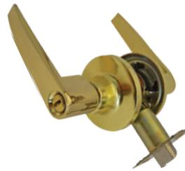
Para contraer el pestillo se puede girar cualquiera de las manijas. Para fijar la manija exterior y colocar el seguro, gira la mariposa interior. Para abrir desde afuera, introduce un desarmador plano o similar en ranura de seguro exterior.
