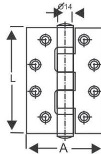
Bisagra en acero inoxidable calidad 304 (Cr 18 y Ni 8) con baleros para marcos de madera y metálicos, perno suelto y doble balero.
