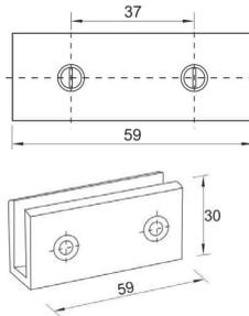
**Clip para entrepaño o cristal fijo de 8 - 10 mm. El cristal no necesita resaque para su fijación. Para cristal templado o sin templar. Para repisas de cristal.**
