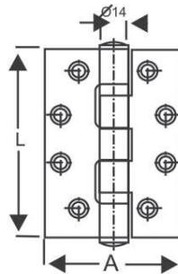
Bisagra en acero inoxidable calidad 304 (Cr 18 y Ni 8) con baleros para marcos de madera y metálicos, perno suelto y doble balero.
