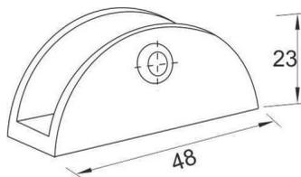
**Clip para entrepaño o para fijo de cristal de 8 a 10 mm. Sin resaque. Fijo de cristal templado o sin templar. El cristal no necesita resaque para su fijación.**
