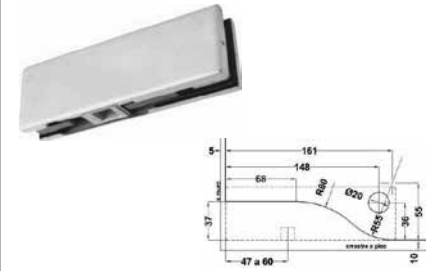
Herraje inferior para bisagra hidráulica. Acabado: Satín y cromo.
