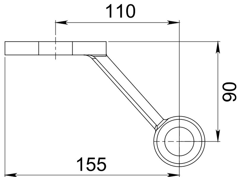
PARA DETERMINAR LA POSICIÓN DEL BARRENO EN EL VIDRIO
