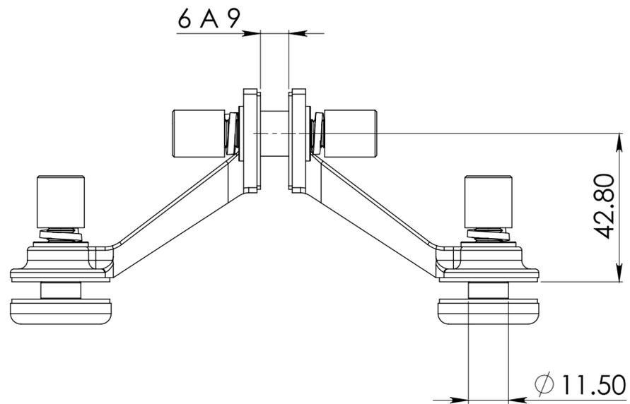
**PARA DETERMINAR LA POSICIÓN DE LOS BARRENOS EN EL VIDRIO**
