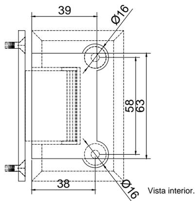
Bisagra muro-vidrio, doble acción con fijación a muro lateral.
